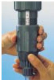
Die Einstellung der Dosierung wird durch das Drehen der Reglerschraube vorgenommen, deren oberer Rand mit dem gewünschten Wert auf der Dosierskala übereinstimmen muss. Die eingespritzte Konzentratsmenge ist proportional zum Wasservolumen, das den Dosatron durch-
